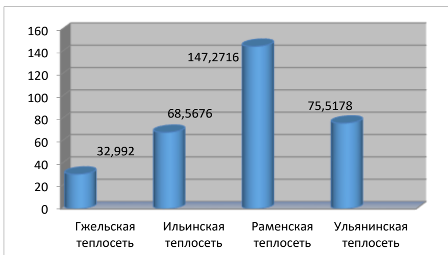
Протяженность тепловых сетей в км по участкам АО «Раменская теплосеть (в 2-х трубном исчислении)
